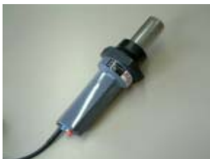
Soufflerie à air chaud
