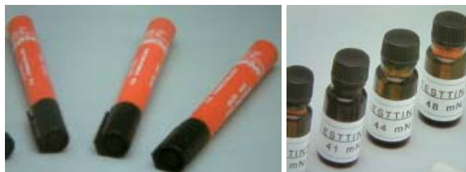
Tiges de contrôle pour le contrôle de la tension superficielle
