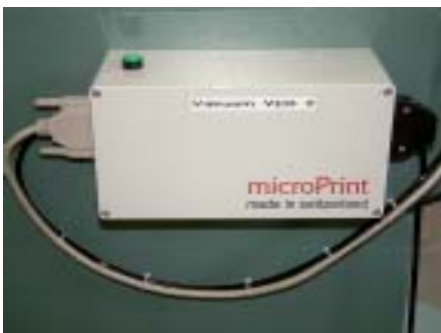
Unité de maintien par dépression et d'éjection par air comprimé VEB2
