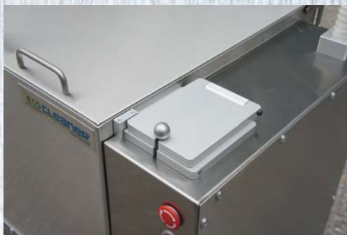
Einfüllstutzen für Adsorber
